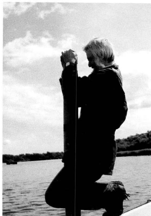
در طراحی یک پروژه بازسازی دریاچه آزمایش استوانه های مغزی رسوب مطلوب بوده و مورد استفاده است. استوانه های مغزی دارای سطح کوچک رامی توان بانمونه گیر های مختلفی بدبست آورده. رسوب تاعمیک مترا بای بشتر رادر دریاچه هایی با بستر های توربی می توان با استفاده از لوله های توخالی به طور کامل برداشت نمود. این لوله ها به طور طولی از وسط بریده شده و بانوارهای ضدآب بهم بسته شده اند. لوله در داخل رسوب فرو می رود و پیش از بیرون کشیدن از آب با یک چوب ینه پلاستیکی، بالای آن بسته می شود.
